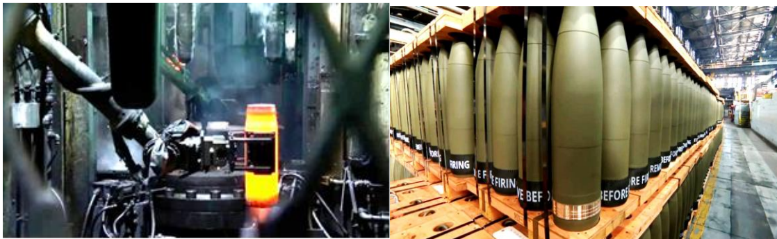
Рис. 1. Встановлення нагрітої заготовки для кування на молоті, а також стелажі з продукцією калібру 155-мм на Скрентонському армійському заводі, США [1]
