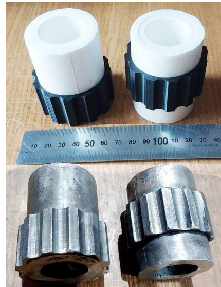
Рис. 1. Виливки за моделями з друківаними полімерними деталями на ППС-підкладці: а – з зовнішньою оболонкою [1]; б – з накладками типу шестерні (з цеху ФТІМС НАН України) [2]
