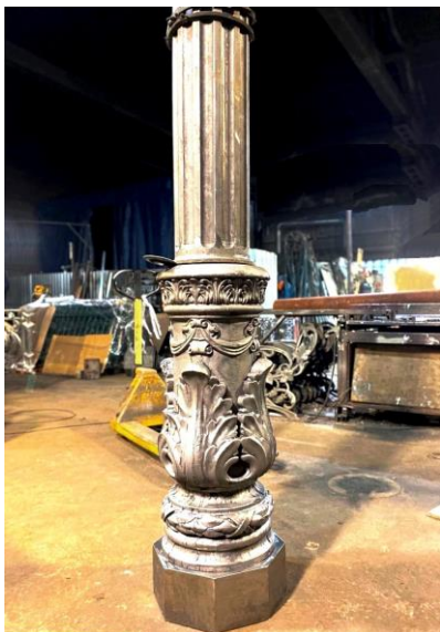
Рис. 1. Чавунна частина колони і її лита деталь за моделлю з друківаними частинами
