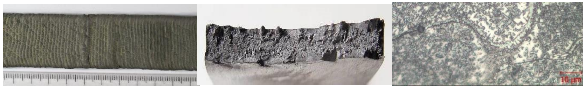
а б в а – зовнішній вигляд, б – злам, в – структура після ТО
