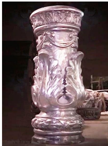
Рис. 1. Чавунна частина колони і її лита деталь за моделлю з друківаними частинами
