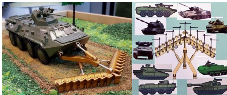
Рис. 2. Макет мінного тралу і види бронетехніки для його застосування
