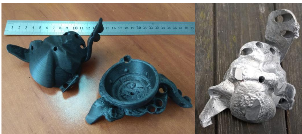
Рис. 2. Моделі та виливок ендопротезу з титанового сплаву [3]
