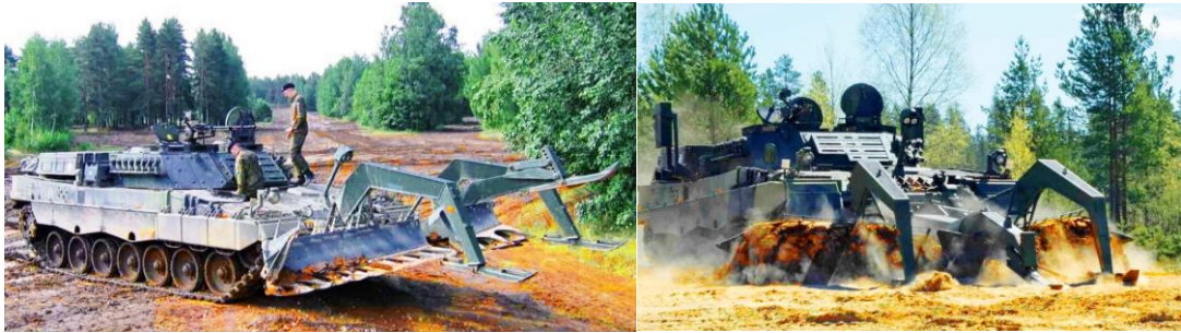
Рис. 1. Танк Leopard 2R в похідному стані і при розмінуванні [1]
