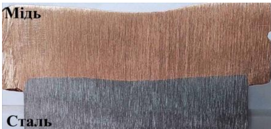
Рис. 1. Вигляд сталемідного з'єднання, отриманого при електрошлаковому наплавленні міді на сталь.
